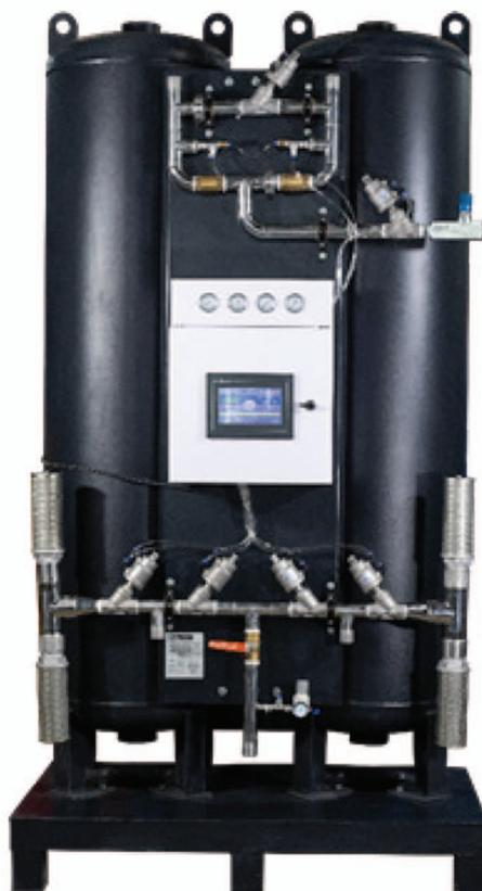
ظرفیت دستگاه اکسیژن ساز NYT- TwinTower
